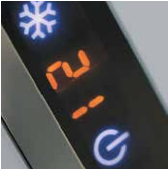
Дисплей Высококонтрастный LED-дисплей отображает выбранный режим работы и температуру воздуха.
